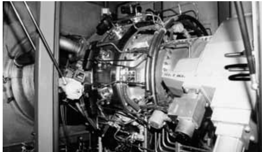
Teilansicht einer heizölbefeuerten Gasturbine; gut sichtbar die Zubringerleitungen für den flüssigen Brennstoff.
