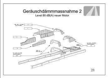
In einer ersten Stufe wird die Geräuschquelle abgeschirmt. Im Laufe der Entwicklung des Aggregates und Verbesserung an der Primärlärmquelle, werden bei gleichem Schallpegel die entsprechenden Sekundär-Massnahmen aus Kosten- und Gewichtsgründen entfernt. Bei Ausführungsvarianten wird nur der sogenannte «Worst-Case» deklariert, das heisst, mögliche geräuschärmere Alternativen werden nicht speziell propagiert.
