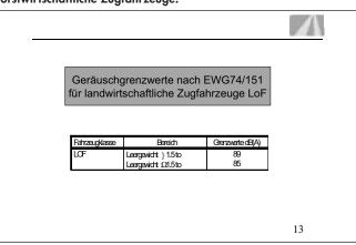
Mit der Übernahme der EG-Richtlinien wurden neue Grenzwerte und eine neue Messmethode eingeführt. Somit kann kein Vergleich über eine Tendenz erstellt werden. Die Grenzwerte in der EWG-Richtlinie sind für diese Fahrzeuge seit 1989 gleich geblieben.
