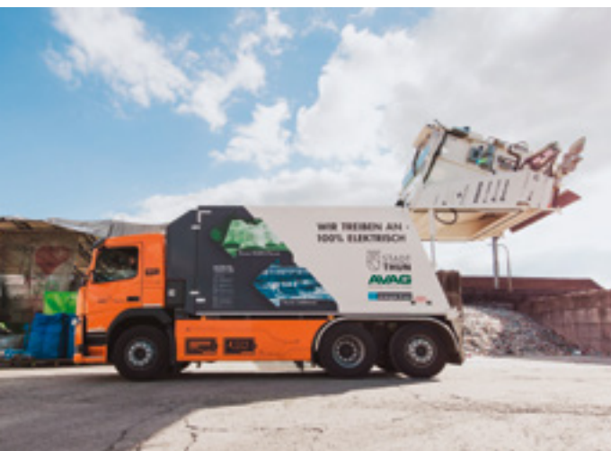
Leistungsstark: Die vier Motoren des «Futuricum 26E» sorgen für eine Gesamtleistung von 680 PS.
